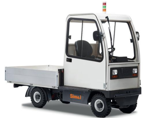
Vierrad-Plattformwagen, Bediener an Bord, Heckantrieb. Sehr kompakt und wendig, ideal für alle inner- und außerbetrieblichen Industrieinsätze, auch über lange Strecken. Der Plattformwagen kann durch zahlreiche Aufbauten an spezielle Einsatzprofile angepasst werden.
